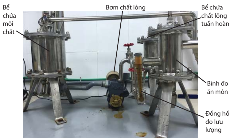
Hình 2. Hệ thiết bị flowloop chế tạo trong phòng thí nghiệm
