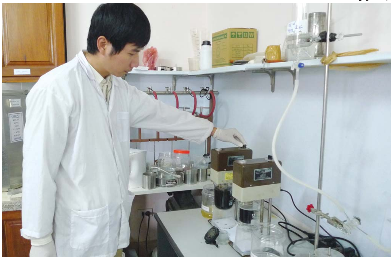
Cán bộ DMC thí nghiệm đo thông số lưu biến của các dung dịch hủy giếng, treo giếng. Ảnh: DMC
