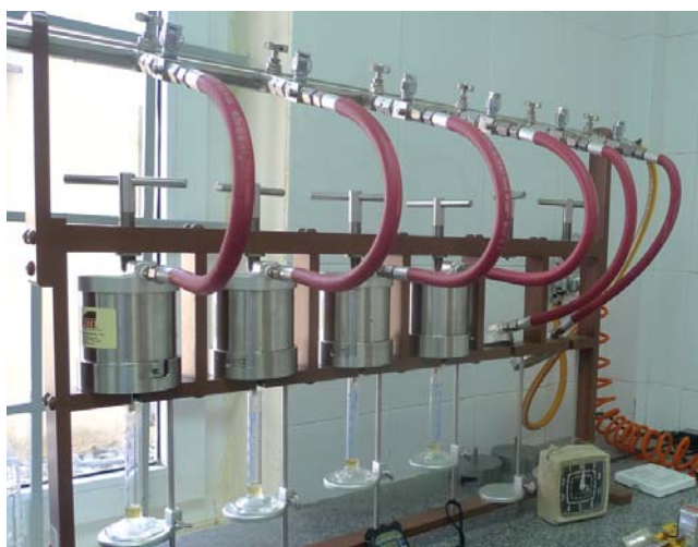
Thí nghiệm đo độ thải nước. Ảnh: DMC
