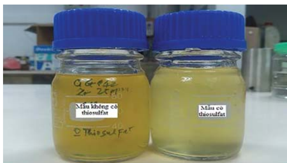
Hình 6. Ảnh hưởng của \text{Na}_2\text{S}_2\text{O}_3 \cdot 5\text{H}_2\text{O} đến khả năng chịu nhiệt của của hệ gel polymer
