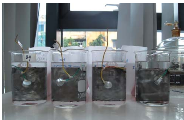
Hình 3. Sơ đồ đo điện thế đóng mạch của anode hy sinh
