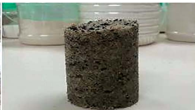
Hình 12. Mẫu mùn khoan ở tầng cát kết Miocene của giếng khoan 507 RC
