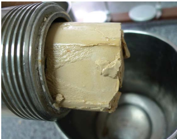
Hình ảnh mẫu dung dịch hủy giếng, treo giếng sau khi thử nghiệm ở nhiệt độ 140^\circ\text{C} . Ảnh: DMC
